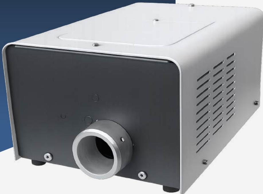
Les générateurs de la série “LA” sont spécifiquement conçus pour être utilisés avec des fibres optiques en verre (version VR) et synthétiques (version SN). Les générateurs sont fournis avec leur ampoule halogène respective de 50W-100W-150W, dont la focalisation est réalisée en usine avec une conception spécialement étudiée par Cobb Fibre Ottiche pour obtenir une concentration maximale du flux lumineux au point d'insertion du connecteur commun.
