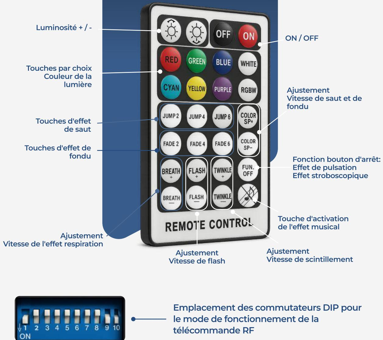
En mode contrôle via télécommande radiofréquence ou application, en plus d'allumer et d'éteindre les lumières, nous pouvons contrôler les couleurs RGB+W, créer diverses scènes lumineuses et régler la vitesse de l'effet scintillant. La télécommande radiofréquence permet de contrôler l'illuminateur même depuis une pièce adjacente au point de positionnement de l'illuminateur.
