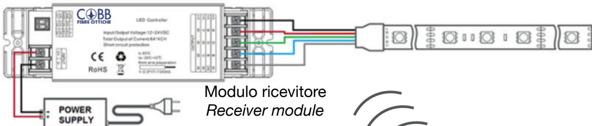
Progettato come controller per strip a LED a tensione costante RGB / RGB+W.
